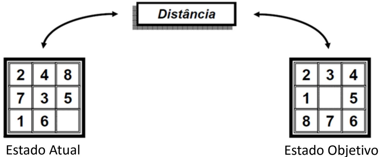
$$h_1 \left( \begin{array}{|c|c|c|} \hline 2 & 4 & 8 \\ \hline 7 & 3 & 5 \\ \hline 1 & 6 & \\ \hline \end{array} \right) = \text{A quantidade de peças for a do lugar} \\ = 7$$
